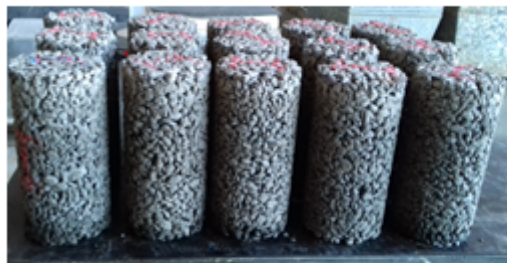
Figura 1. Corpos de Prova após serem desmoldados
