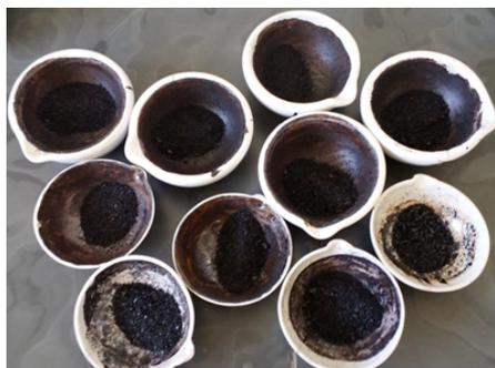
**Figura 3.** Amostras em processo de incineração para determinação da percentagem de cinzas.
